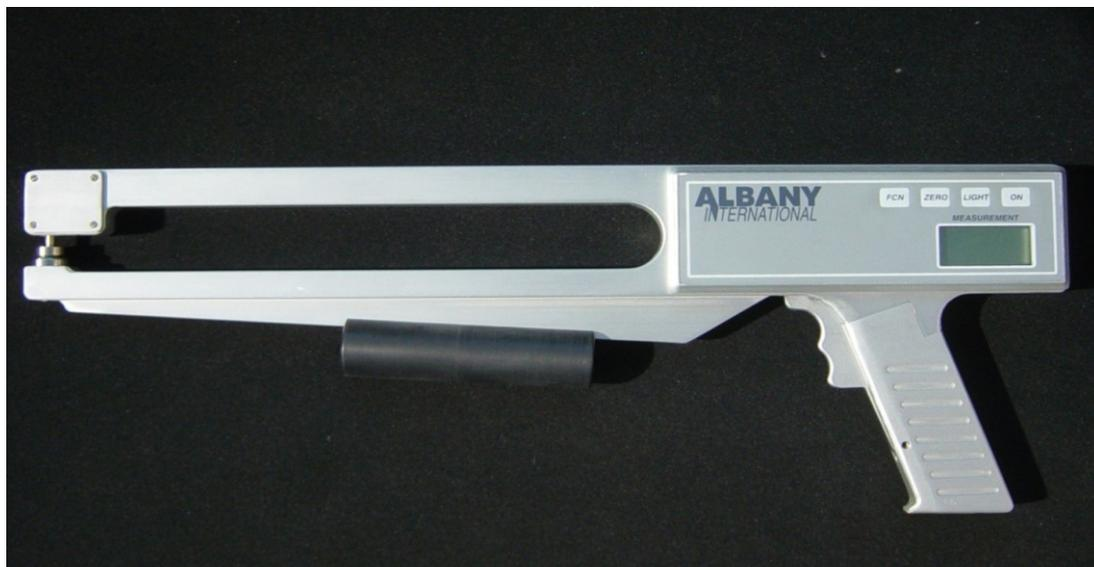
Figura 1: Medidor de espessura.
