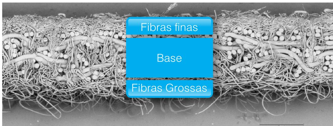
Figura 1: Corte transversal de um feltro úmido.
